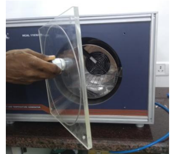
STEP – 3 : Remove the Acrylic door
